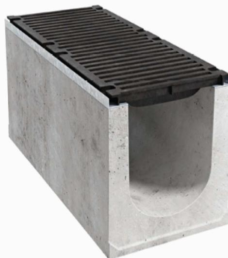
Il **profilo di protezione** ad L è realizzato in acciaio **S235 JR** con trattamento superficiale di zincatura a caldo, provvisto di inserti filettati M12 per il fissaggio della griglia in ghisa sferoidale F900.
