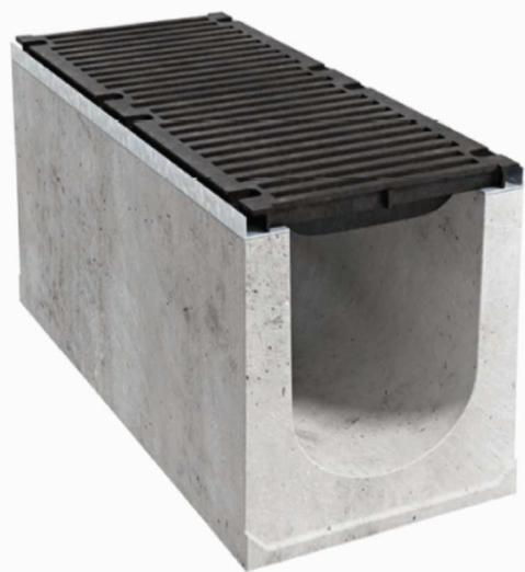
Il **profilo di protezione** ad L è realizzato in acciaio **S235 JR** con trattamento superficiale di zincatura a caldo, provvisto di inserti filettati M12 per il fissaggio della griglia in ghisa sferoidale D400.
