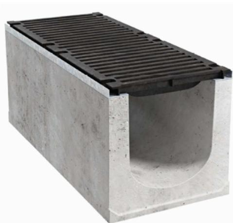
Il **profilo di protezione** ad L è realizzato in acciaio **S235 JR** con trattamento superficiale di zincatura a caldo, provvisto di inserti filettati M12 per il fissaggio della griglia in ghisa sferoidale D400.
