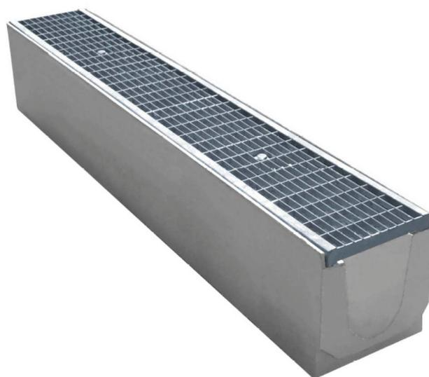
Il **profilo di protezione** ad L è realizzato in acciaio **S235 JR** con trattamento superficiale di zincatura a caldo, provvisto di alloggiamenti elastici per il fissaggio centrale della griglia in acciaio zincato in classe di carico B125.
