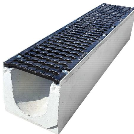
**Il profilo di protezione** ad L è realizzato in acciaio **S235 JR** con trattamento superficiale di zincatura a caldo, provvisto di inserti filettati M10 per il fissaggio delle griglie in ghisa sferoidale D400.
