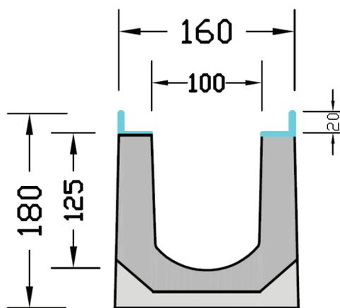
(\*) La portata idraulica è fornita a titolo indicativo, calcolata per una lunghezza di 10 metri di canalizzazione, con scarico a bocca piena, libero di impedimenti. Il ns. ufficio tecnico è a disposizione per dimensionamenti e calcoli idraulici in fase progettuale.
