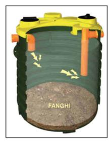
Le fosse settiche costituiscono un affidabile dispositivo per il **trattamento primario** dei reflui, si tratta di sistemi di depurazione passivi, molto stabili, semplici e poco costosi; sono impiegate come trattamento primario delle acque nere provenienti dai WC a servizio di scarichi domestici o assimilabili.
